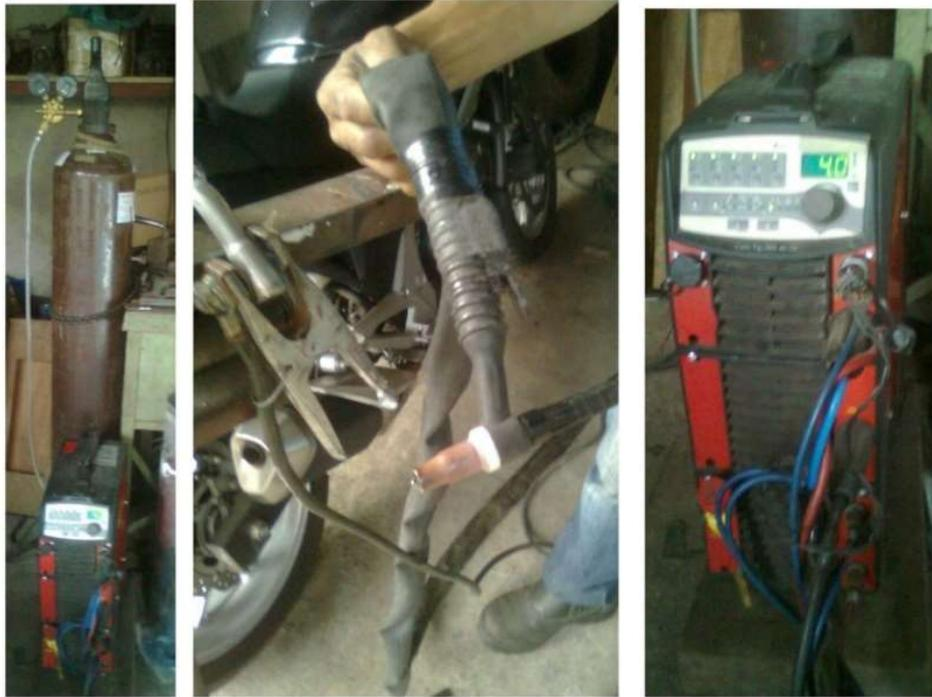
Figura 21: Equipamento de soldagem TIG
