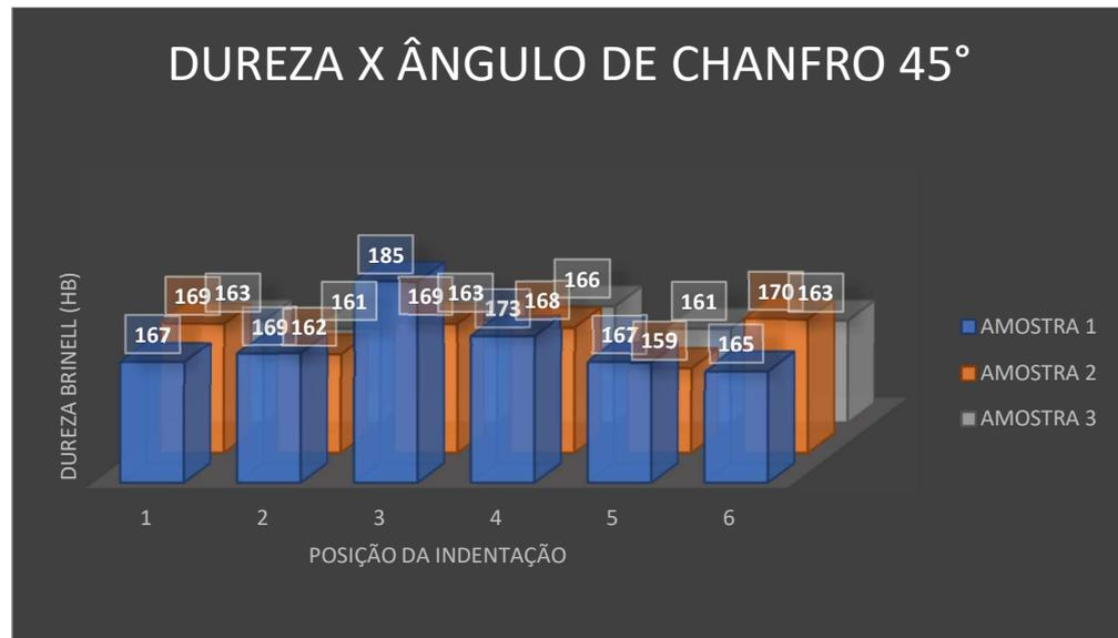
Figura 30: Gráfico referente às medidas de dureza nos CP's com ângulo 45° de chanfro
