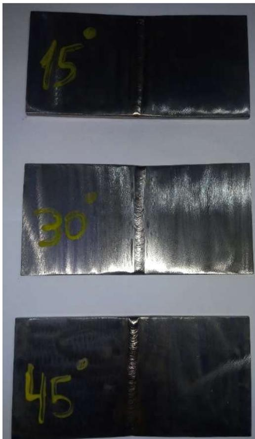
Figura 22: Corpos de prova após processo de soldagem
