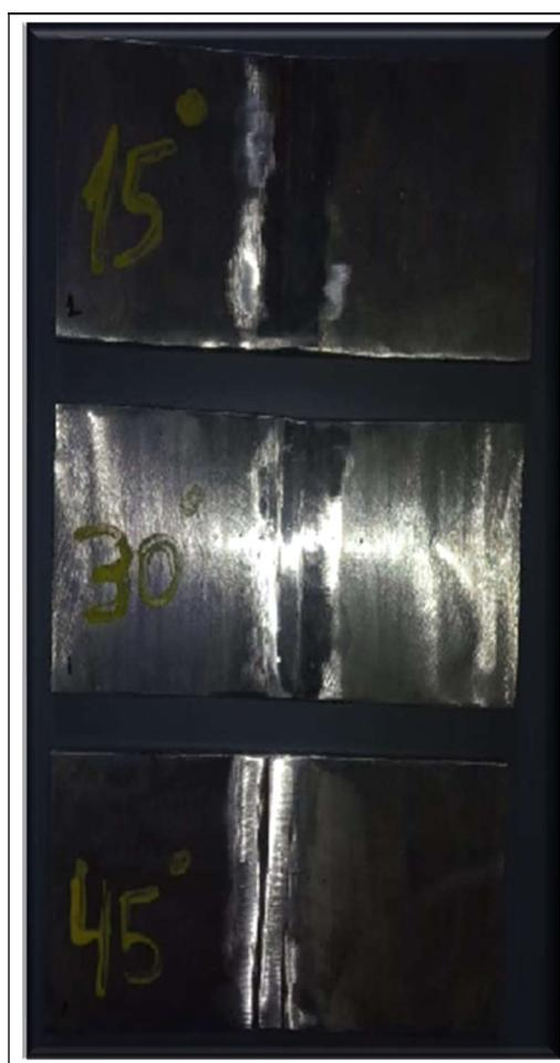
Figura 24: Corpos de prova após processo de lixamento
