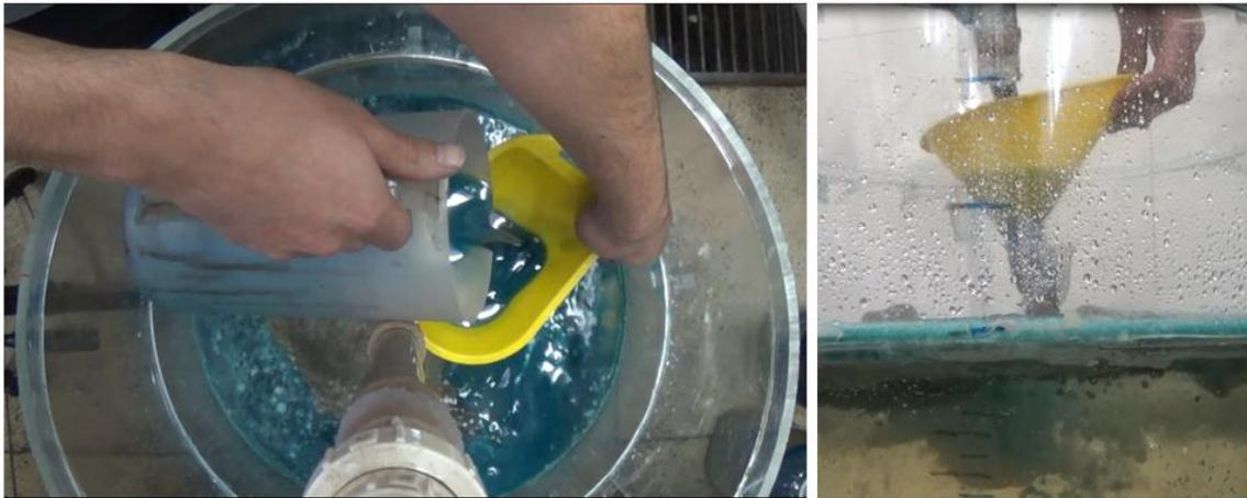
Figura 4.15 - Preparação do teste de emulsão: (a) Vista superior; (b) Vista frontal.
