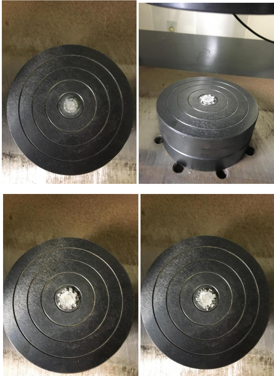
Figura 48 - Aspectos das amostras após os ensaios de compressão. (a) Alumínio puro, (b) Al-5% de resíduo de minério de manganês sinterizado a 550°C, (c) Al-10% de resíduo de minério de manganês sinterizado a 550°C e (d) Al-15% de resíduo de minério de manganês sinterizado a 550°C.
