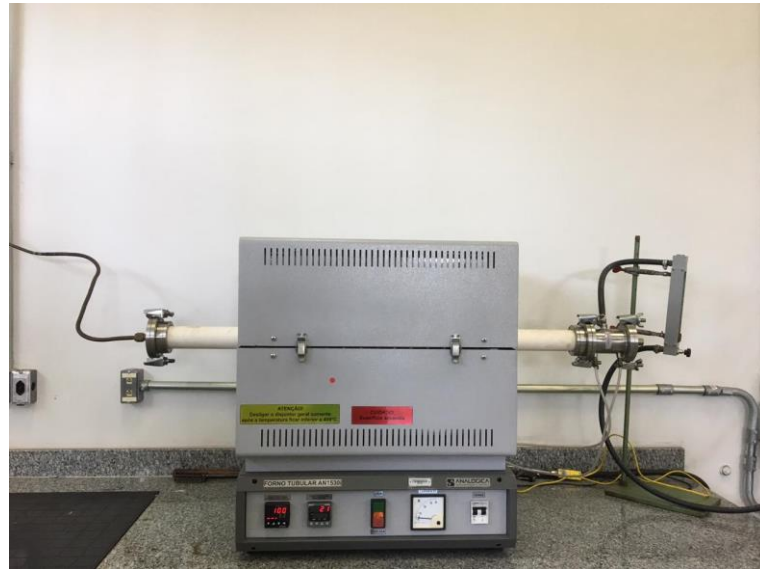
Figura 11 - Forno tubular da marca Analógica utilizado na sinterização. Fonte: Pesquisa direta (2020).
