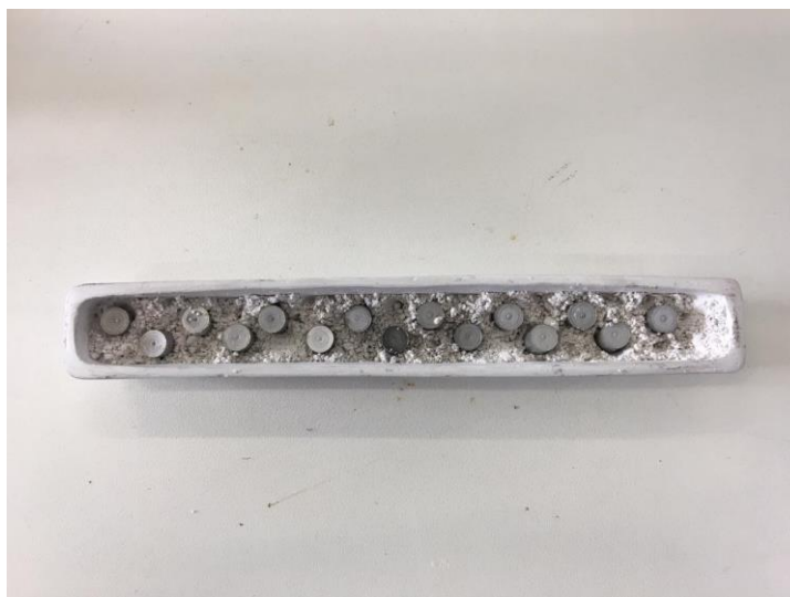
Figura 10 - Aspecto dos compósitos na barquinha após a sinterização. Fonte: Pesquisa direta (2020).
