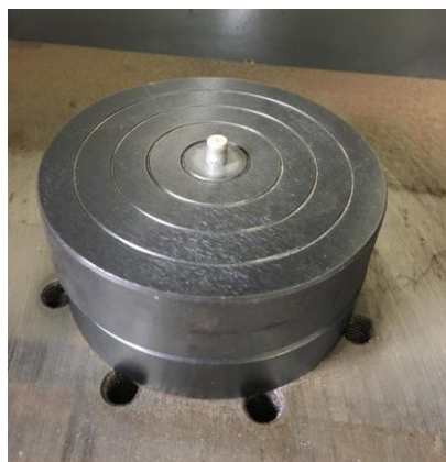
Figura 15 - Amostra posicionada para realização do ensaio de compressão. Fonte: Pesquisa direta (2020).
