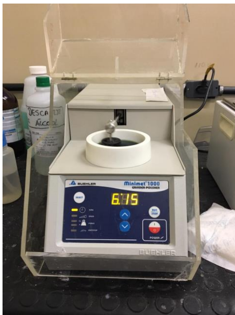
Figura 13 - Politriz metalográfica semiautomática, Minimet 1000, utilizada para o polimento mais fino das amostras. Fonte: Pesquisa direta (2020).
