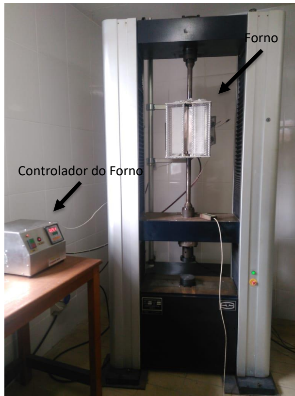
Figura 7 - Fotografia do forno resistivo acoplado à máquina universal de ensaios
