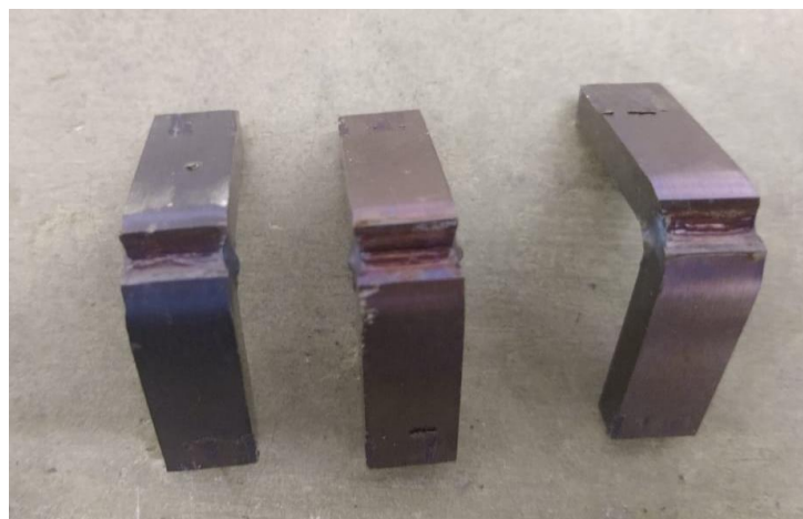
Figura 18 - Corpos de prova ensaiados a 600^{\circ}\text{C} apresentando o fenômeno de fragilização azul.
