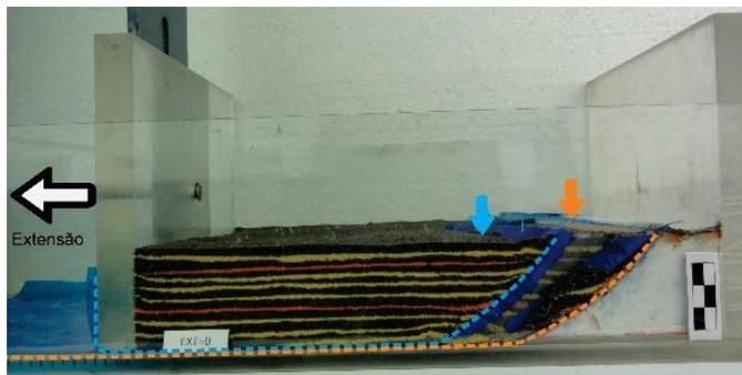
**Figura 4.10** - Vista em perfil do Experimento 3 após o preenchimento com areia e antes da deformação. A linha tracejada em azul representa o plástico que ao ser puxado pela parede móvel, durante a primeira extensão, gerou a bacia mais antiga na região, indicada pela seta azul. A linha e a seta laranja representam o plástico e respectiva região de formação do rifte na segunda fase.
