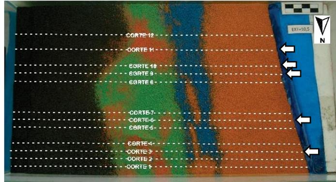
**Figura 4.11** - Fotografia do Experimento 3, em planta ao final da deformação, com a localização dos cortes efetuados no experimento e com a indicação (seta) daqueles representados a seguir.
