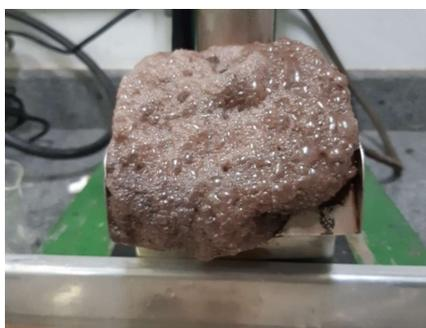
Experimentalmente, observou-se que os testes utilizando o bagaço da cana-de-açúcar apresentaram maior quantidade de espuma, como ilustrados nas Figuras 15 e 16.
