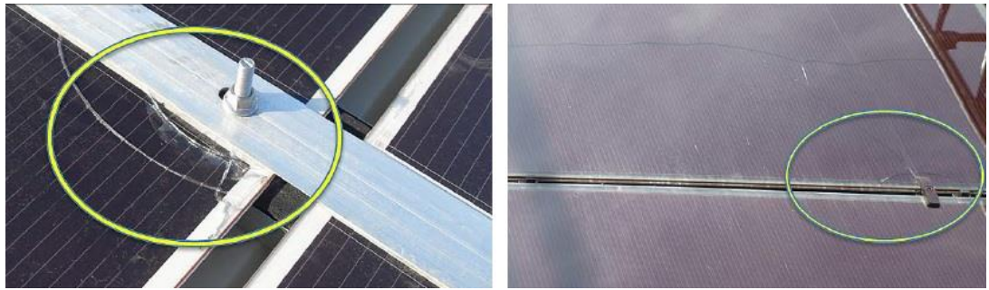
Figura 8: Rottura del vetro dovuta il clamping [7]
