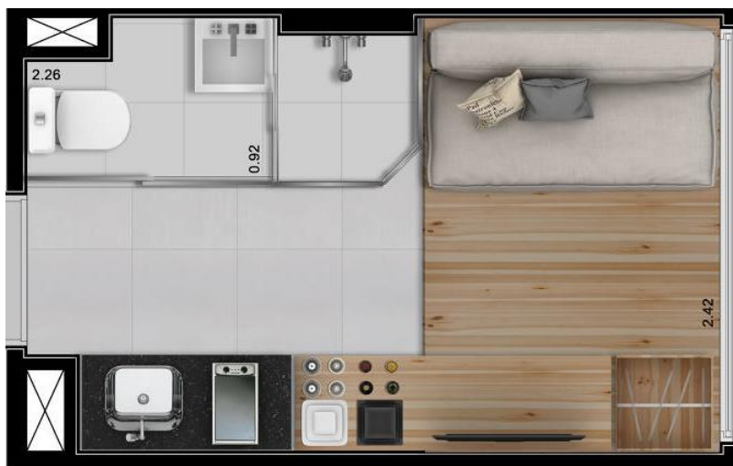
Figura 2: Planta tipo de micro apartamento com menos de 20m 2 demonstra a redução extrema dos espaços de habitação e a integração total dos cômodos.
