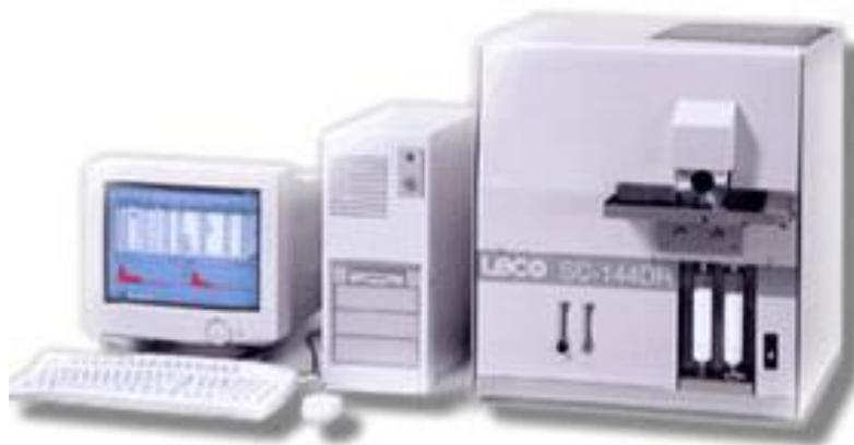
Figura 8: Equipamento para análise elementar (LECO, 2013).
