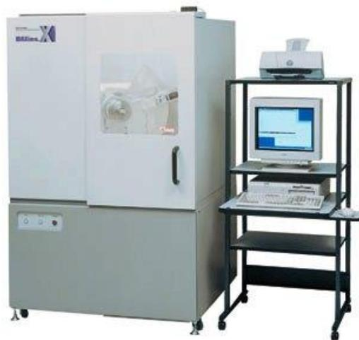
Figura 11: Imagem do difratômetro de raios X (SHIMADZU, 2013).
