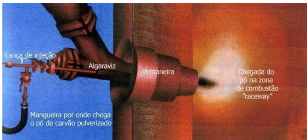
Figura 7: Sistema de injeção das ventaneiras e *raceway* do alto-forno (MOURÃO, 2007).
