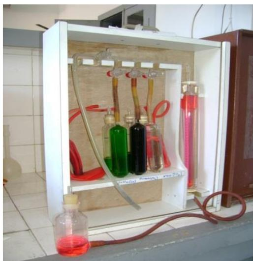
Figura 15: Vista de um ORSAT do laboratório de Siderurgia, Escola de Minas-UFOP.
