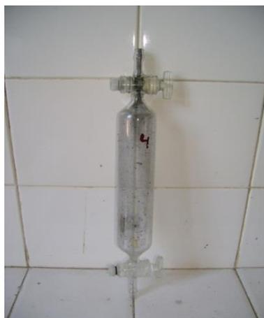
Figura 14: Ampola utilizada para coletar o gás gerado no simulador de elevado gradiente térmico.
