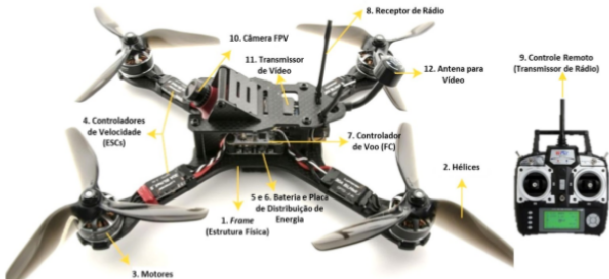
Figura 33 – Modelo de quadricóptero com seus componentes em destaque
