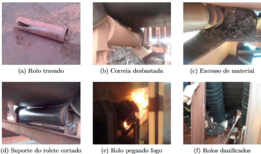
Figura 19 – Algumas falhas em rolos e suas consequências
