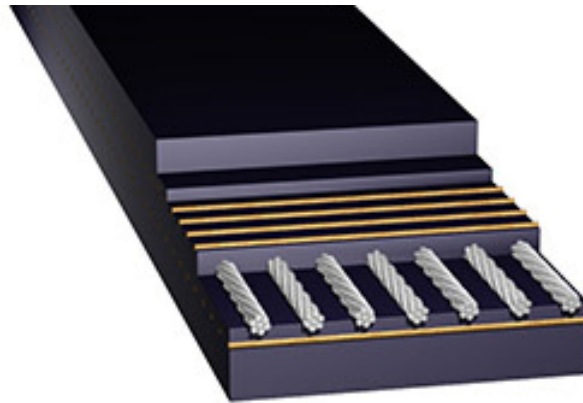
Figura 6 – Esquema das partes que compõe uma correia transportadora
