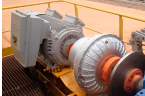
Figura 17 – Acoplamento hidrodinâmico ligado ao motor
