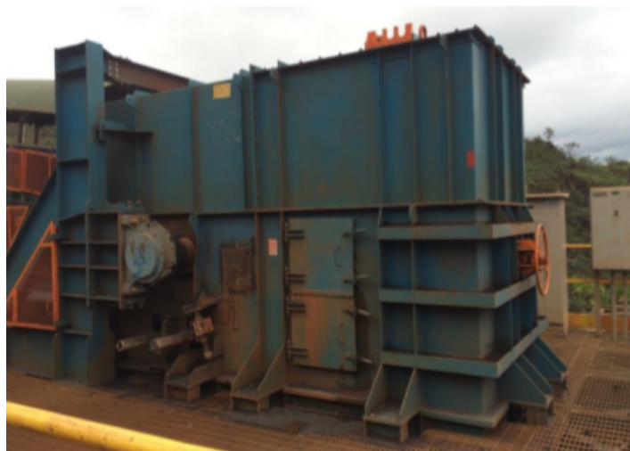
Figura 18 – Visão externa de um chute de minério da Sandvik MGS S/A
