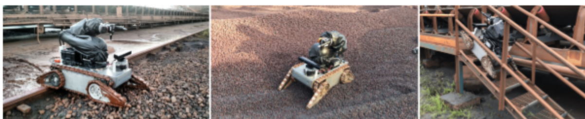
Figura 29 – Dispositivo robótico atravessando um trilho do trem, locomovendo-se em uma pilha de pelotas e subindo escadas
