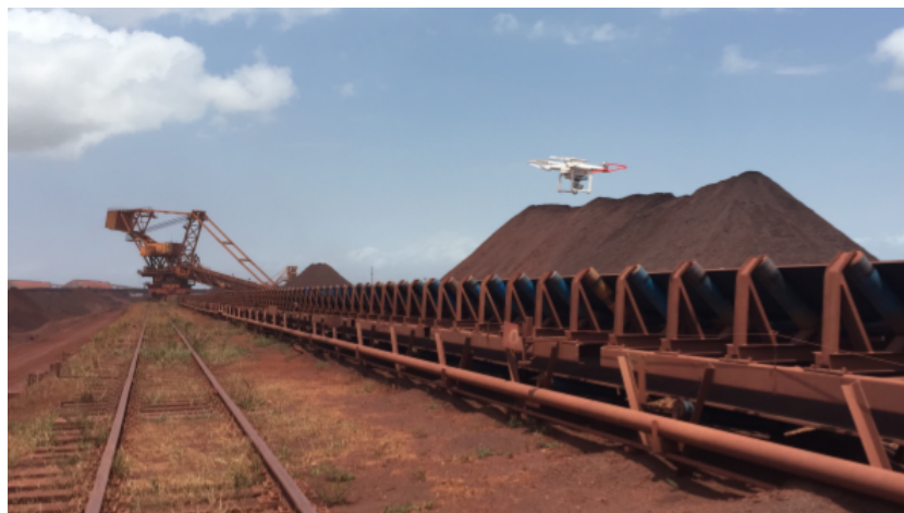
Figura 34 – Voo realizado pelo RPA para coletar imagens dos rolos do transportador de correia
