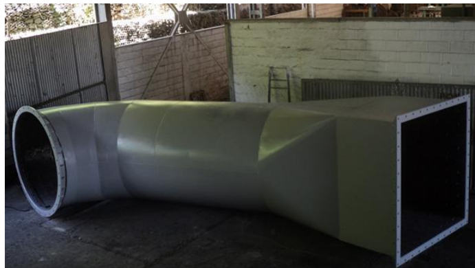
Figura 7: Fabricação de tubulação com 2000 mm de diâmetro.
