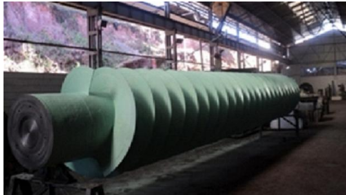
Figura 9: Recuperação total em rosca transportadora de 12m de comprimento e 2m de diâmetro.
