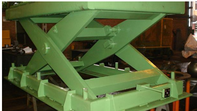
Figura 10: Fabricação mesa de elevação.
