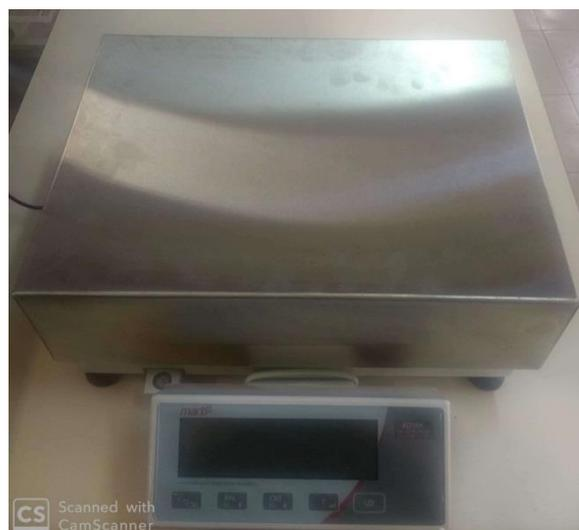
Figura 4. 4 - Balança de precisão Marte AD16K do laboratório de Pirometalurgia do DEMET/UFOP.
