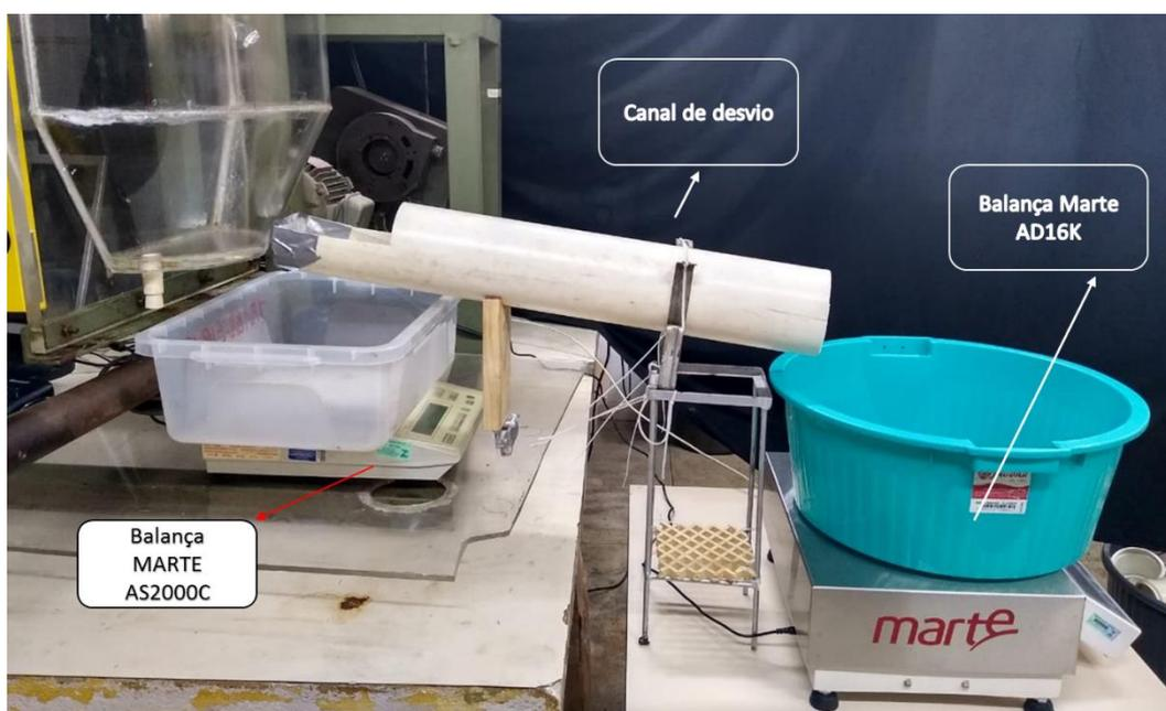
Figura 4. 5 – Configuração de duas balanças.
