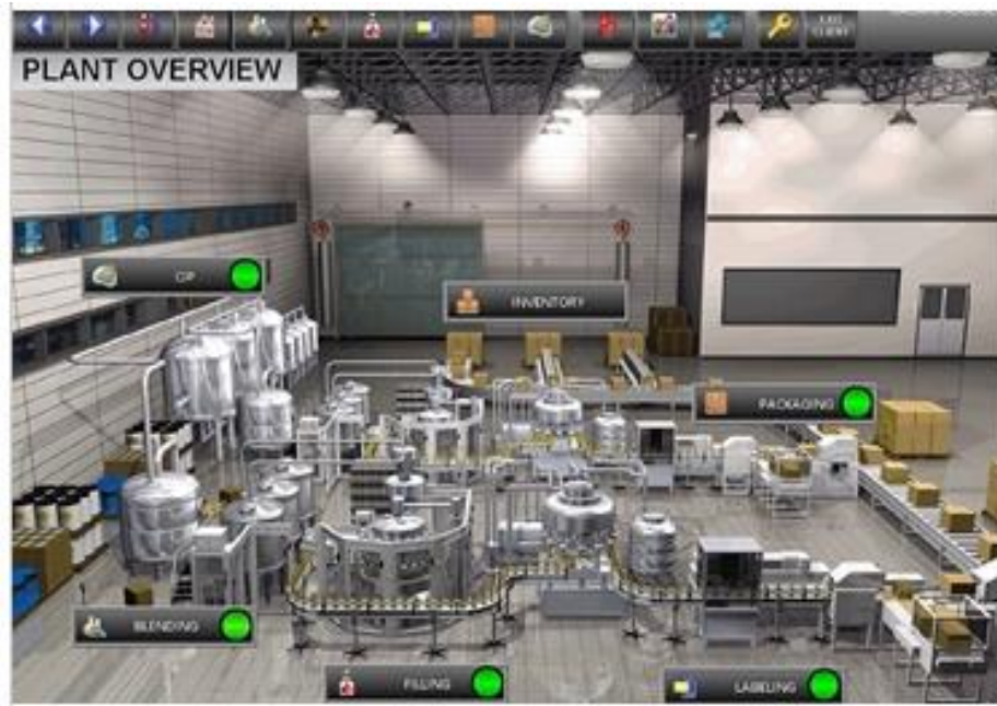
Figura 4.14 – Exemplo de Sistema Supervisório
