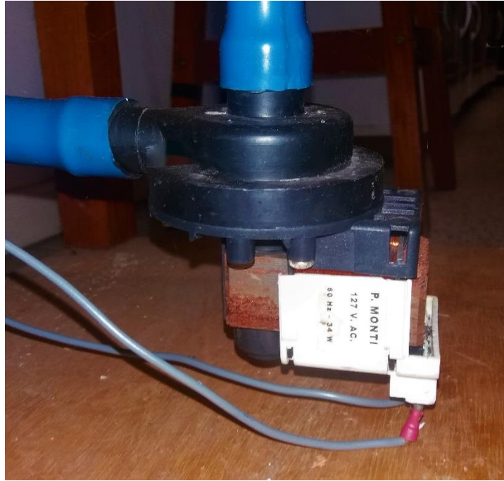
Figura 5.4 -Eletrobomba de água.
