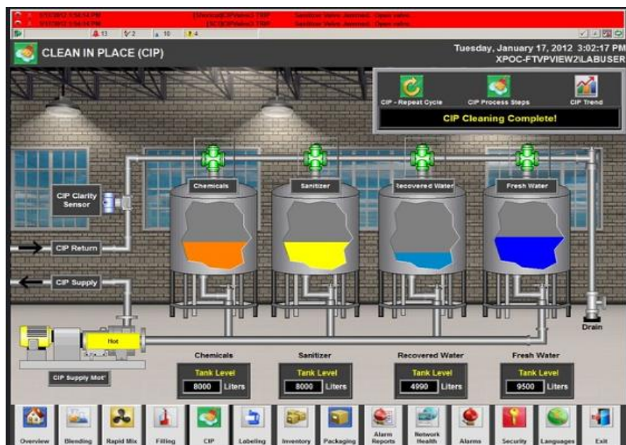
Figura 4.15– Exemplo de Sistema Supervisório
