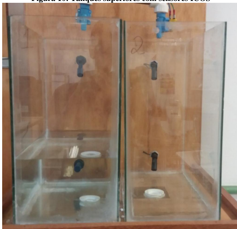
Figura 10: Tanques superiores com sensores ICOS
