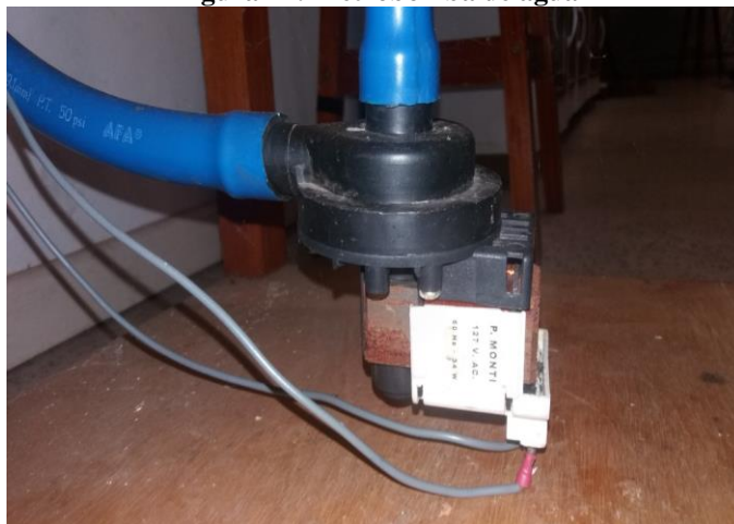
Figura 12: Eletrobomba de água
