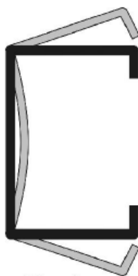
Figura 6 - Flambagem distorcional em seção U enrijecido. Fonte: Silva e Silva (2008)
