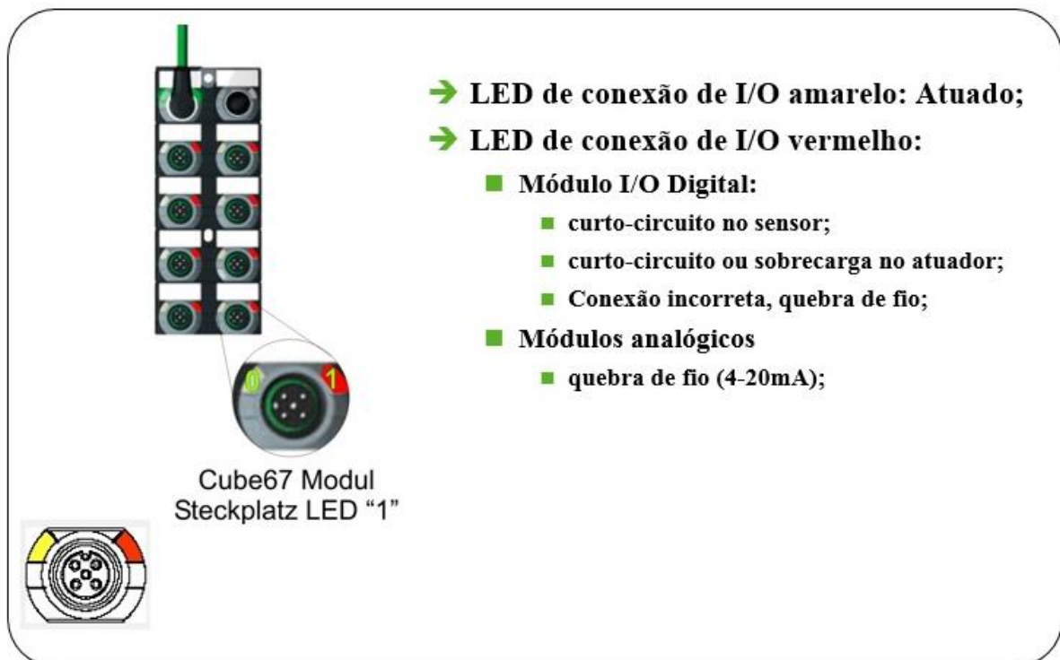
FIGURA 3.2 – Diagnósticos dos leds do módulo de I/O.
