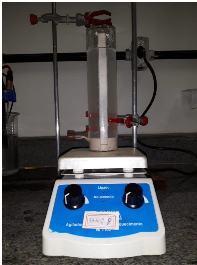
Figura 9 - Tubo de agregação imediatamente após sedimentação
