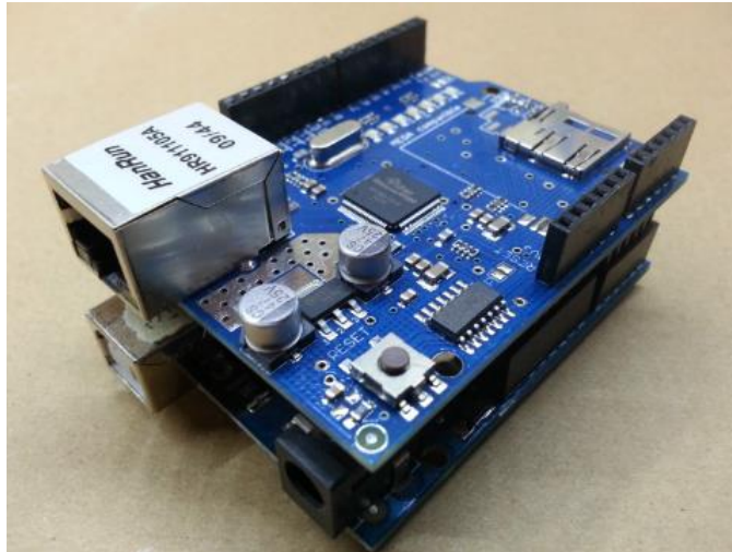
Figura 25. Shield Ethernet acoplado ao Arduino. Fonte: Site codeproject 15 .
