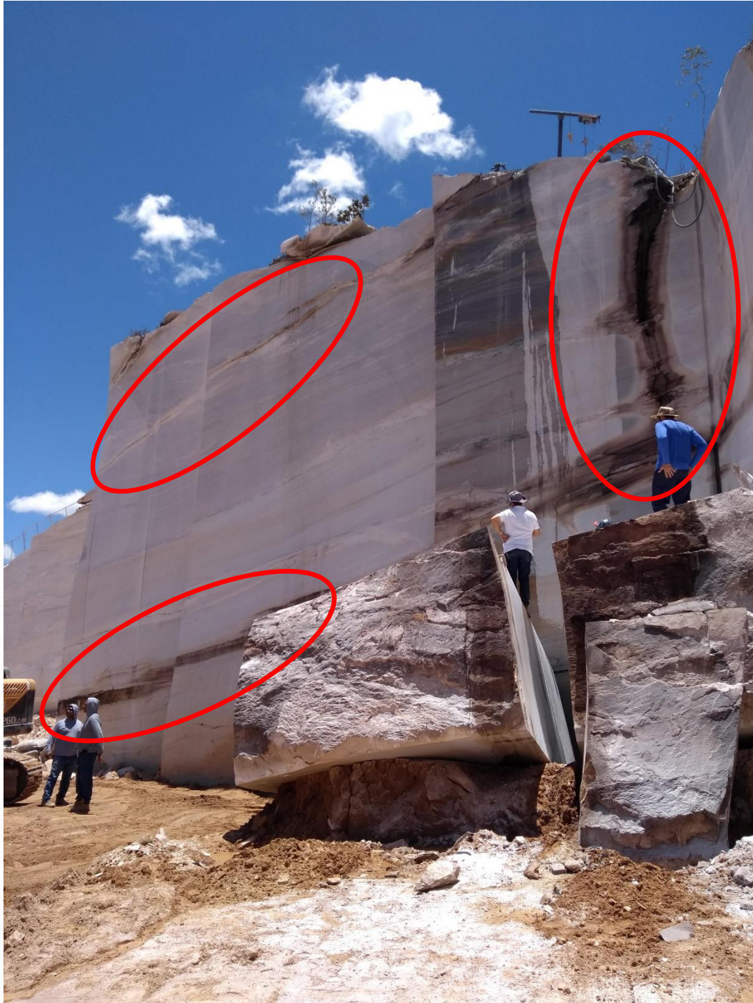
Figura 3.11: Lavra de quartzito por bancadas altas em Gouveia, MG, com destaque para as principais descontinuidades presentes no maciço. Fonte: acervo do autor, 2019.
