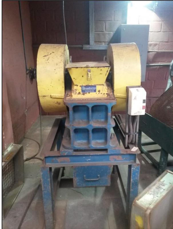
Figura 26 - Britador de Mandíbulas Brasmix (Brastorno)
