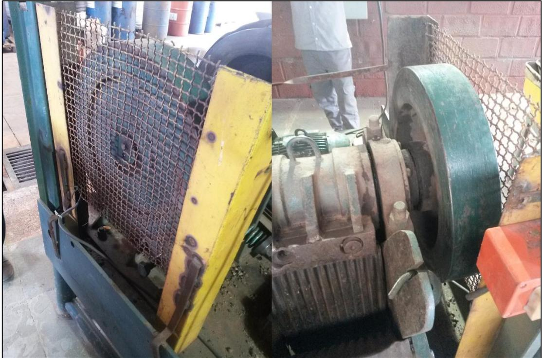
Figura 16 - Proteção do rotor de inércia
