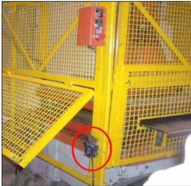
Figura 3 - Proteção móvel de uma zona de prensagem com intertravamento
