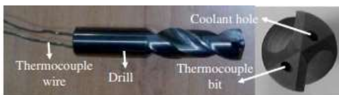
Figura 7- Posicionamento dos termopares nos canais de refrigeração da broca Fonte: Çakiroglu e Acir (2013)
