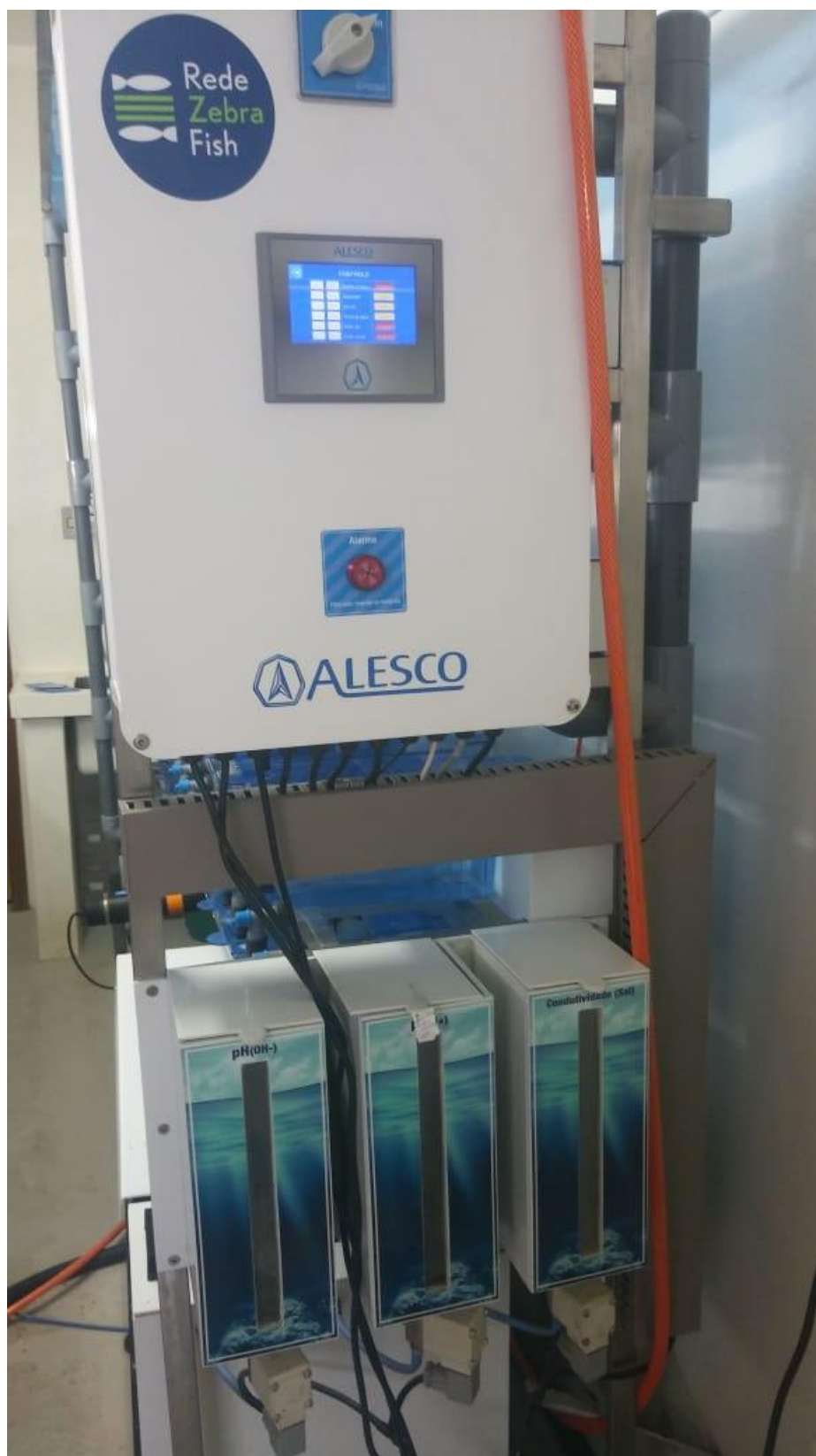
Figura 16: Sistema anexado nas estruturas dos aquários que garante o controle automático da qualidade da água.
