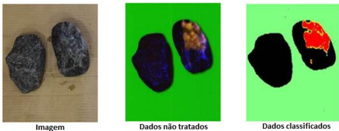
Figura 3.3 - Efeito do espalhamento do raio laser em materiais diferentes, auxiliando na determinação da composição das amostras (Merlyn Consulting 2016).
