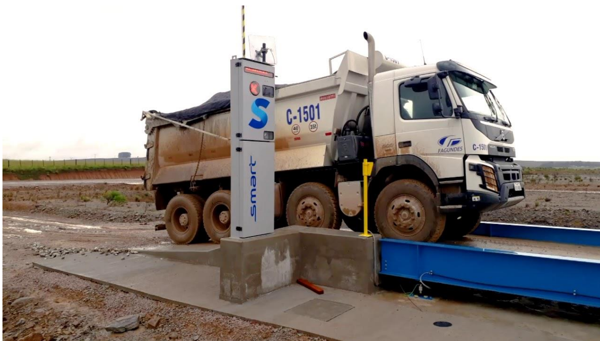
Figura 5- Balança rodoviária utilizada na medição da carga dos caminhões
