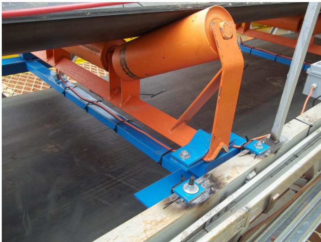
Figura 6- Exemplo de montagem de uma balança integradora
