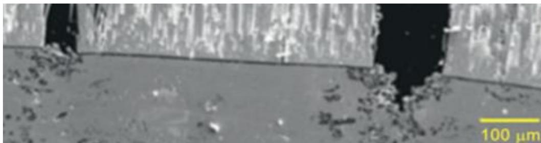
Figura 21 – Microscopia da amostra falha por fadiga termomecânica
