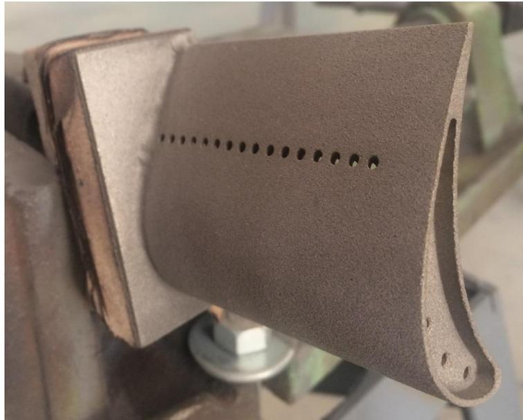
Figura 15 - Peça com revestimento térmico
