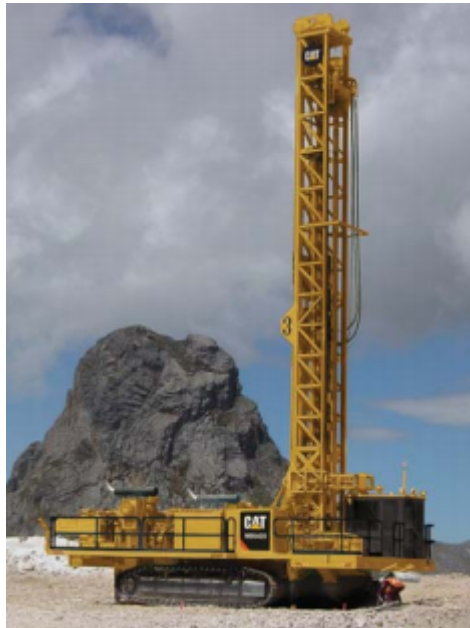
Figura 6 – Perfuratriz de Esteiras Grande Porte
