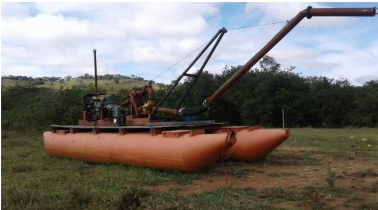
Figura 10 – Balsa que será adquirida e utilizada para sucção de areia do Rio Jacaré
