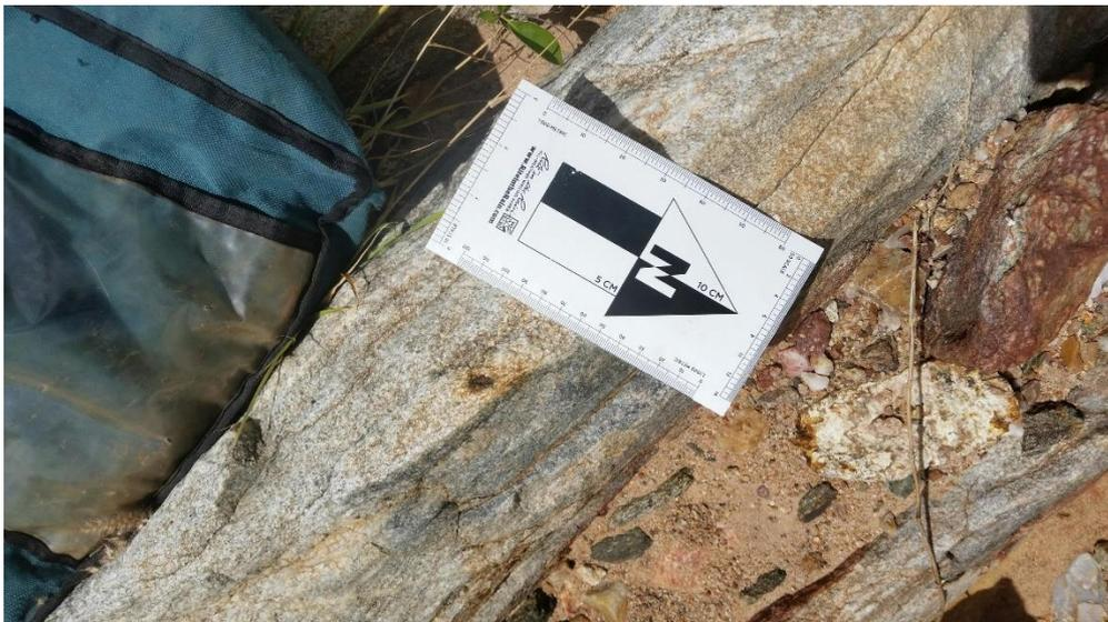
**Figura 5.6** - Ortognaisse migmatítico como rocha encaixante da intrusão ultramáfica.
