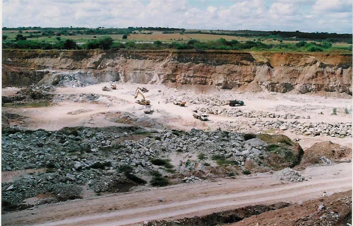
Figura 4 – Lavra de gipsita da Mineração Campo Belo de Araripina-PE. Fonte: (BALTAR, LUZ e BASTOS, 2005)
