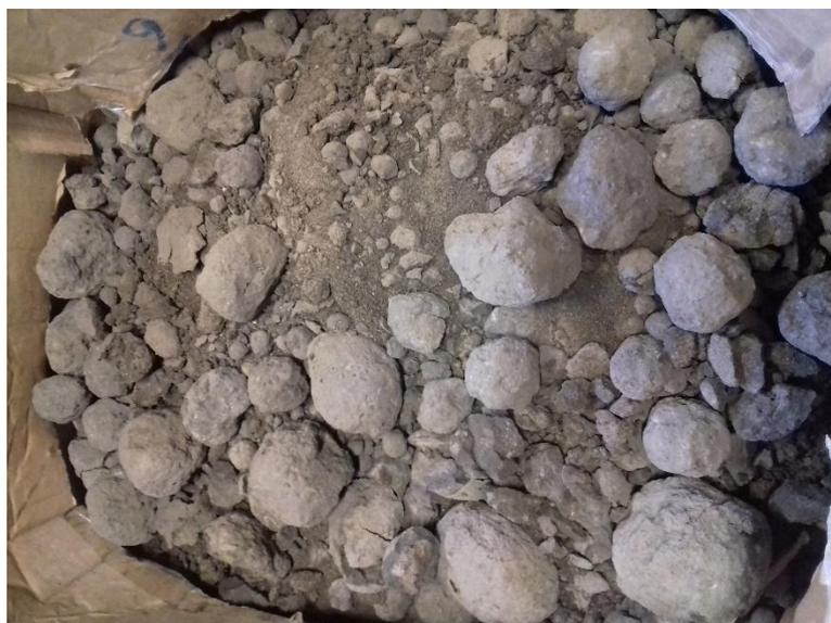
Figura 2 – Clínquer após processo de fabricação. Fonte: autor.
