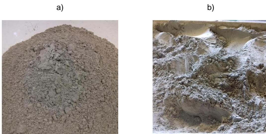
Figura 11 – CPI-gesso (a) e CPI-fosfogesso (b) produzidos. Fonte: autor
