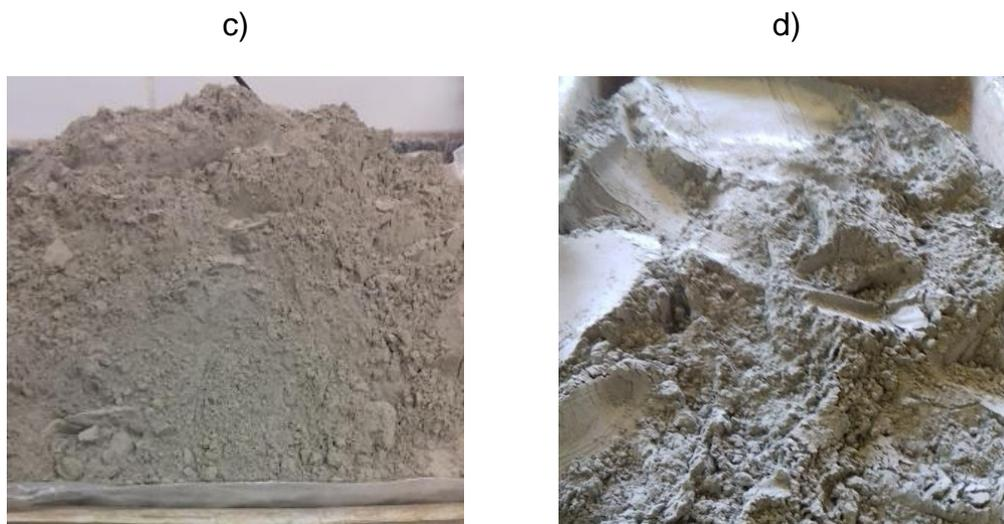
Figura 9 - Processamento do clínquer para produção do Cimento Portland tipo I: a) Clínquer fornecido por indústria nacional; b) Clínquer cominuído no triturador de mandíbula; c) Clínquer moído no moinho de bolas; d) Cimento produzido. Fonte: autor
