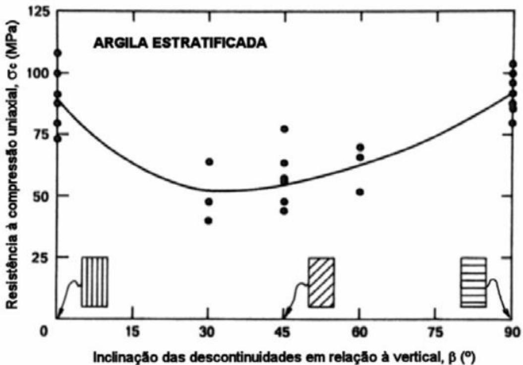
Figura 10 - Influência da orientação das descontinuidades na resistência de uma argila estratificada. Fonte: Pinho, 2003.
