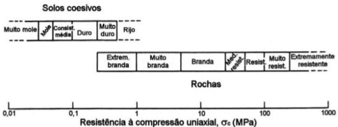
Figura 5 - Definição de rocha branda de acordo com a *ISRM*, 1978. Fonte: Pinho, 2003.
