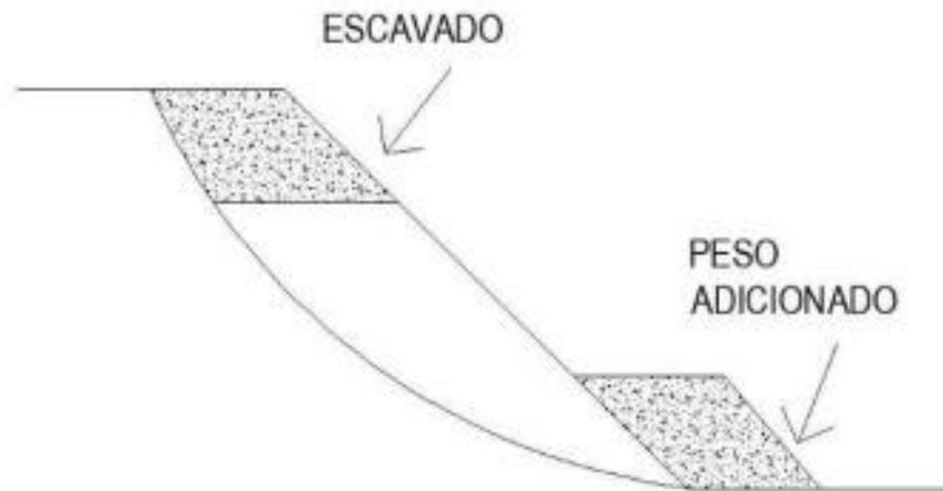
**Figura 32** - Retirada da parte superior do talude para o pé do talude. Fonte: Oliveira, 2010.
