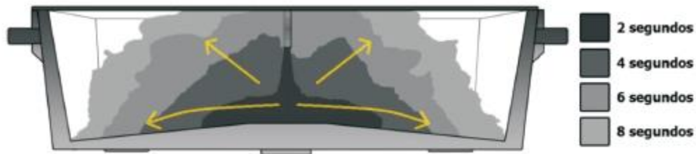
Figura 3.7: Teste em distribuidor sem presença de barragens (DARSIE et al. 2014).
