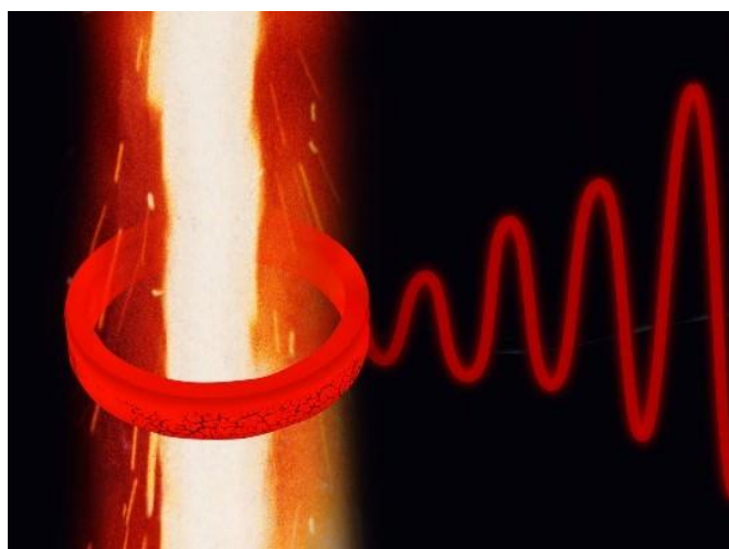
Figura 3.2 - Esquema de espiras do sistema de detecção EDS de passagem de escória.
