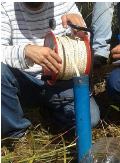
Figura 2- Medidor de nível d'água (REY, 2016)
