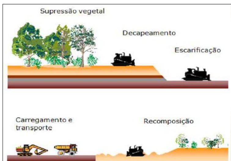
Figura 7: Operações unitárias do método de lavra por tiras.
