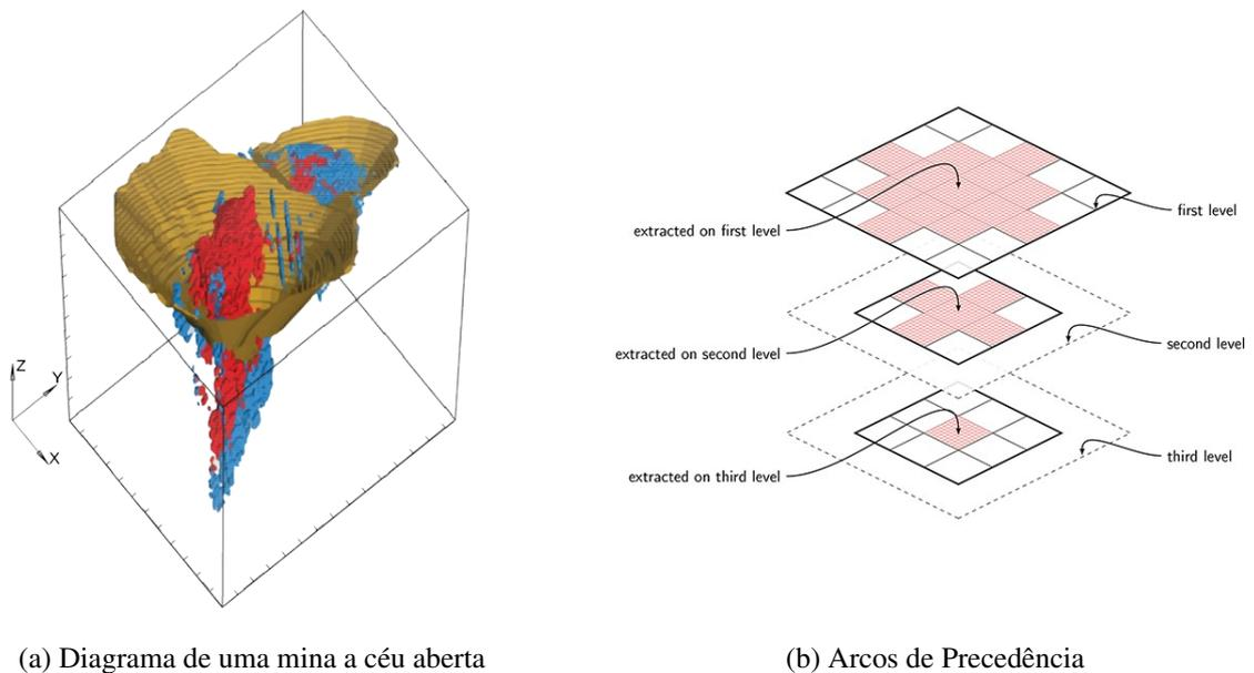
Figura 1 – Diagrama de blocos e Relação de precedência
