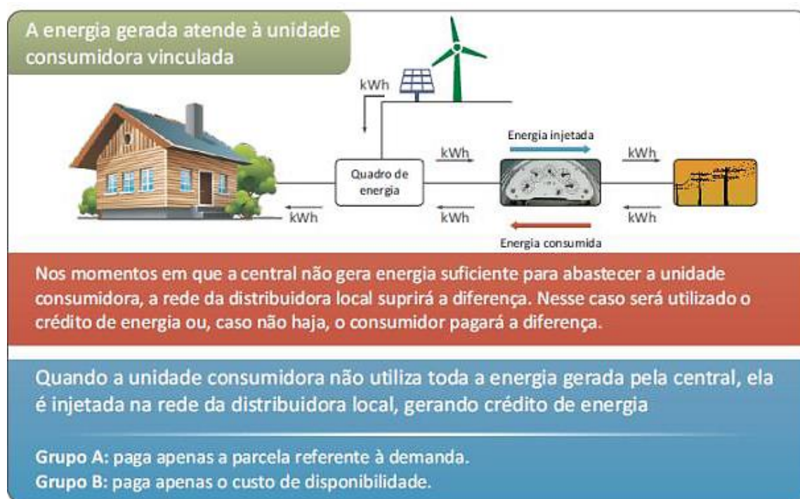
Figura 4 – Demonstração do sistema de compensação de energia elétrica.
