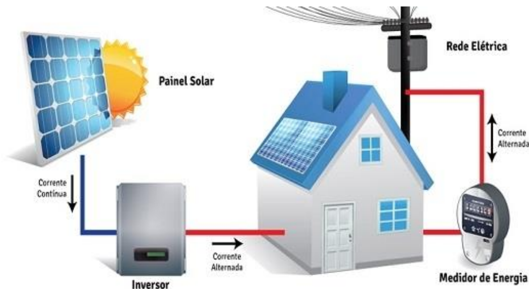
Figura 3 – Esquema dos componentes de um Sistema Fotovoltaico Conectado à Rede.
