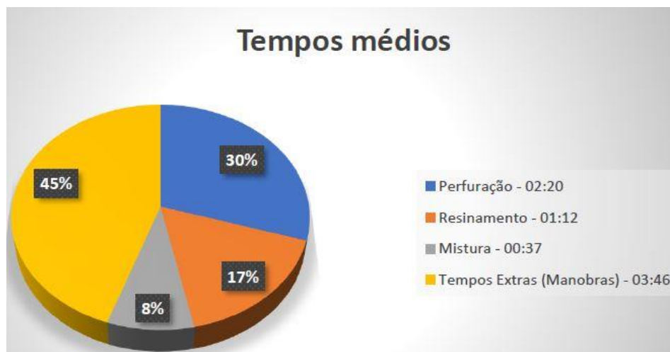
Figura 4.2 – Tempos médios na instalação de tirantes com resinas (MecRoc, 2018)
