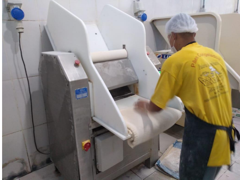
Figura 8: Foto do processo de compactação da massa no cilindro. . Fonte: Pesquisa direta (2019).
