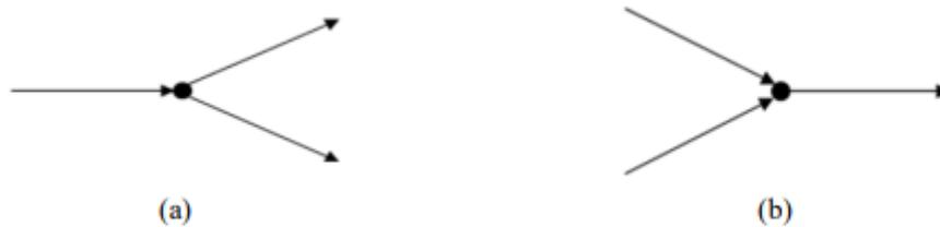
Figura 2.1 - Representação dos nós: a) de separação, b) de junção (Wills & Napier-Munn, 2006)
