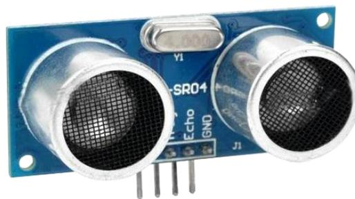
Figura 3.5 – Sensor ultrassônico HC-SR04.
