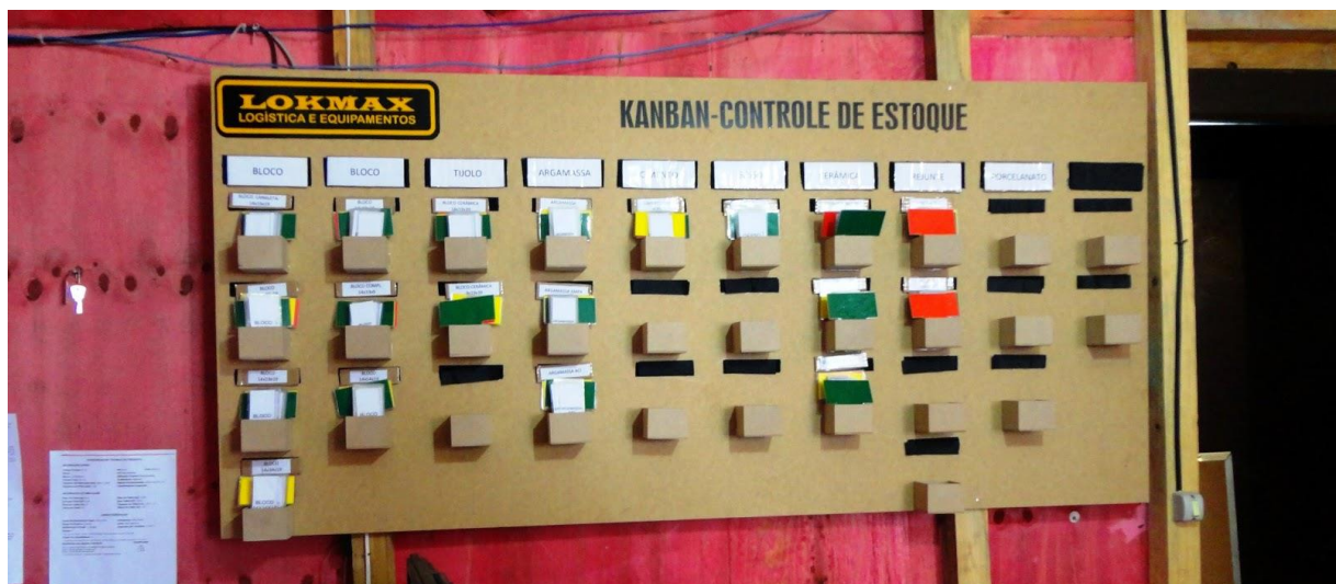
Figura 7 – Kanban no formato de cartões utilizado na obra da LokMax Logística e Equipamentos para controlar o estoque. Fonte: (LOKMAX, 2015).
