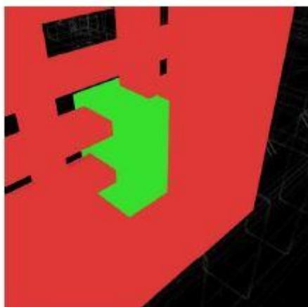
Figura 20 – Identificação de incompatibilidade entre as disciplinas de arquitetura e elétrica. Interferência entre caixa de tomada e parede de cobogó. Fonte: (GUIMARÃES, 2019).
