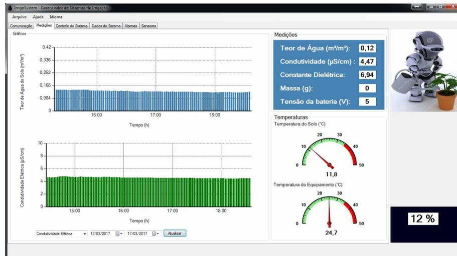
Figura 26 – Programa de computador para aquisição de dados e interface com o usuário
