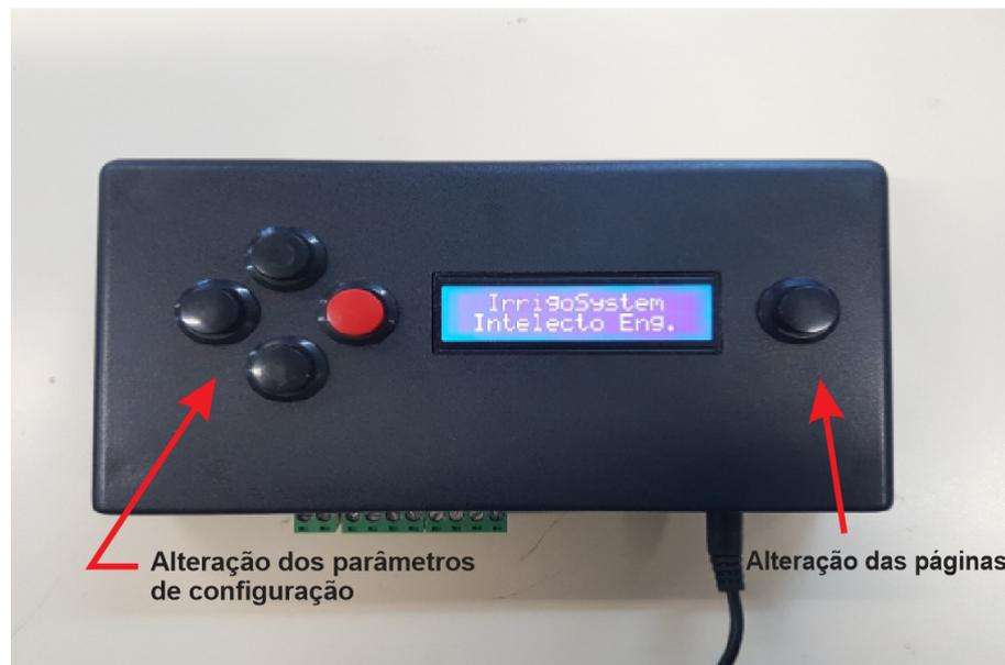
Figura 28 – Detalhe dos botões e dos LEDs do painel controlador.
