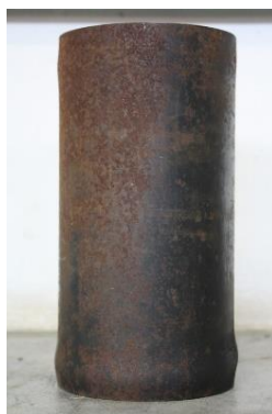
Figura 4.6 - Deformação da parede do tubo do protótipo sem concreto.
