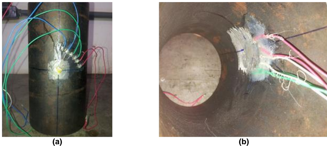
(a) (b) Figura 3.3- Disposição dos extensômetros externos (a) e internos (b). Fonte: (Natalli, 2017)
