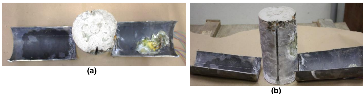
Figura 4.8 - Perfil tubular do protótipo CLEX-102x1,9-SM aberto após o ensaio.
