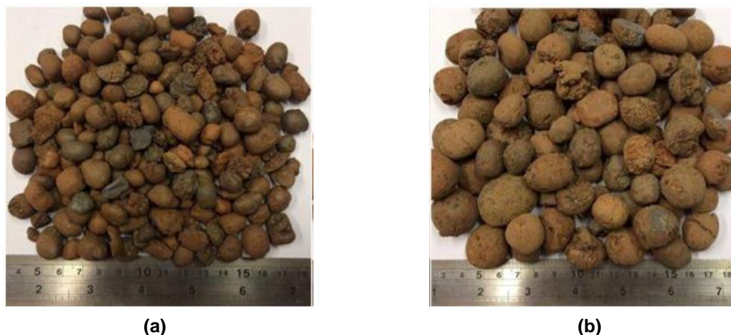
Figura 2.1 - Agregados leves utilizados na matriz cimentícia do concreto leve: (a) CINEXPAN 1506 (b) CINEXPAN 2215. Fonte: (Natalli, 2017)
