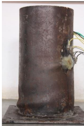
Figura 4.4- Deformação na parede do tubo do protótipo CLSA-102x1,9-SM após ensaio de compressão.
