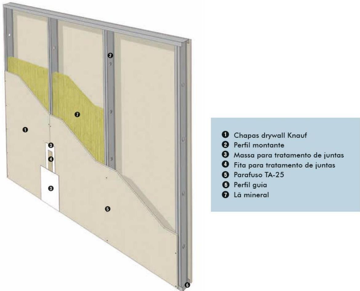
Figura 1 – Parede de Drywall W111.
