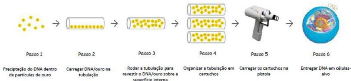
**Figura 4:** Esquema do processo de transformação mediado por biobalística
