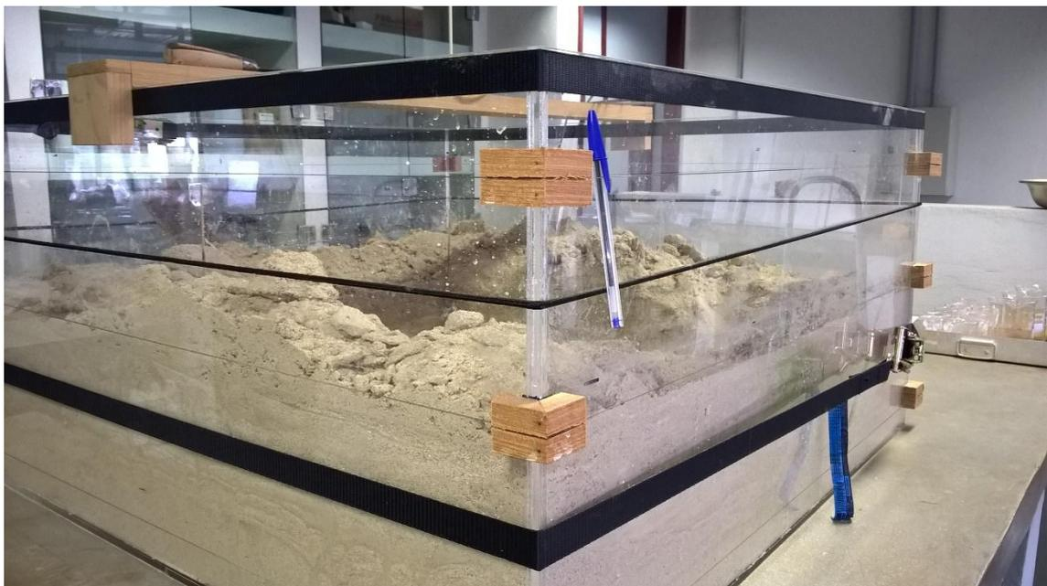
Figura 3.1 Tanque utilizado para a realização dos ensaios. Todo o material foi elaborado e confeccionado por Moreira (2016).
