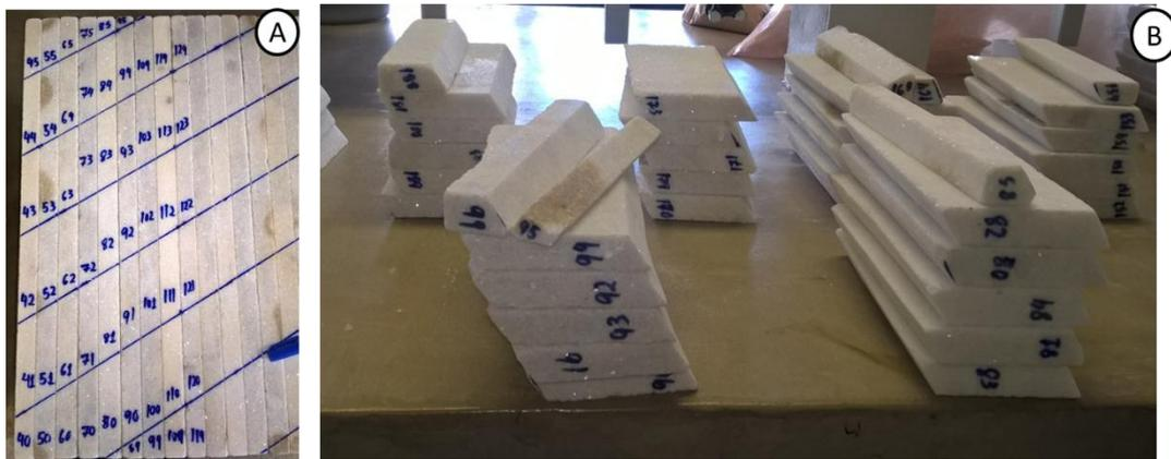
Figura 3.3 A) Placas alinhadas, numeradas e com a direção do corte definido. B) Pedacos do mármore após o corte.
