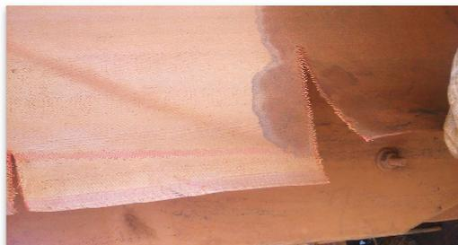
**Figura 10: Desgaste do Apalpador.**
