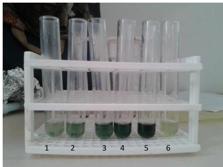
**Figura 12:** Soluções de ácido gálico em diferentes concentrações: Tubo 1: 10  $\mu\text{g/ml}$ , Tubo 2: 20  $\mu\text{g/ml}$ , Tubo 3: 30  $\mu\text{g/ml}$ , Tubo 4: 40  $\mu\text{g/ml}$ , Tubo 5: 50  $\mu\text{g/ml}$  e Tubo 6: extrato etanólico dos frutos de *G. ulmifolia* na concentração de 100  $\mu\text{g/ml}$ .
