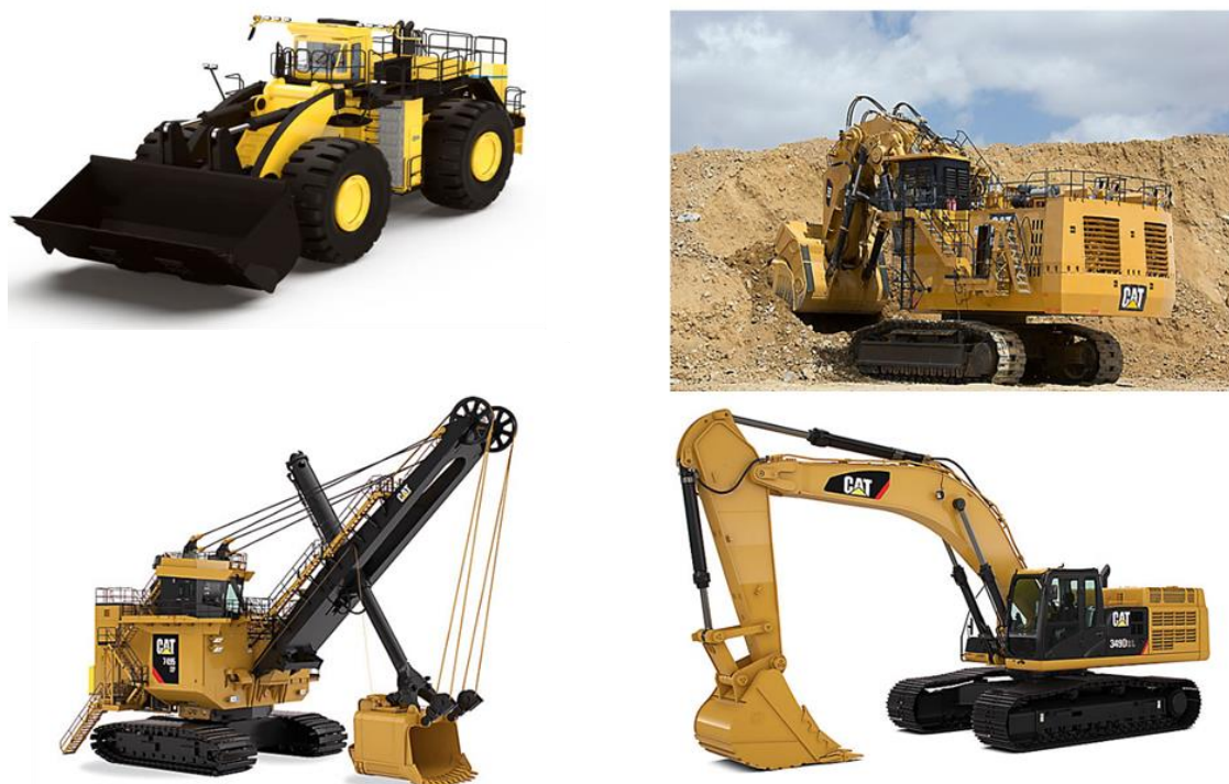
Figura 4: Equipamentos de carregamento. I- Pá carregadeira; II- Escavadeira hidráulica; III- Escavadeira a cabo; IV- Retroescavadeira. Fonte: Caterpillar, 2019.
