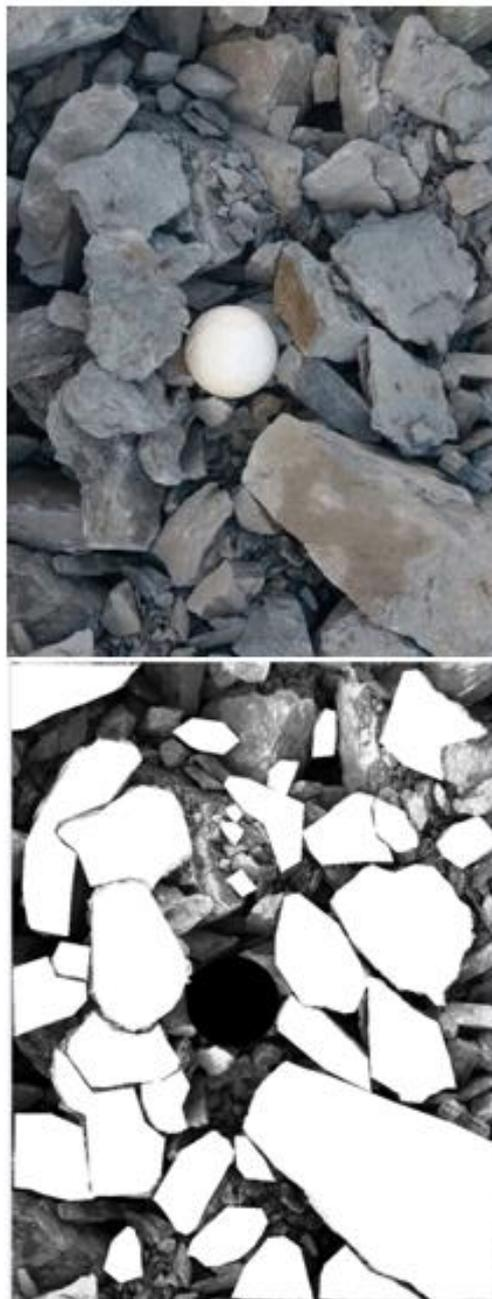
Figura 20 - Análise Granulométrica após desmonte 003/17
