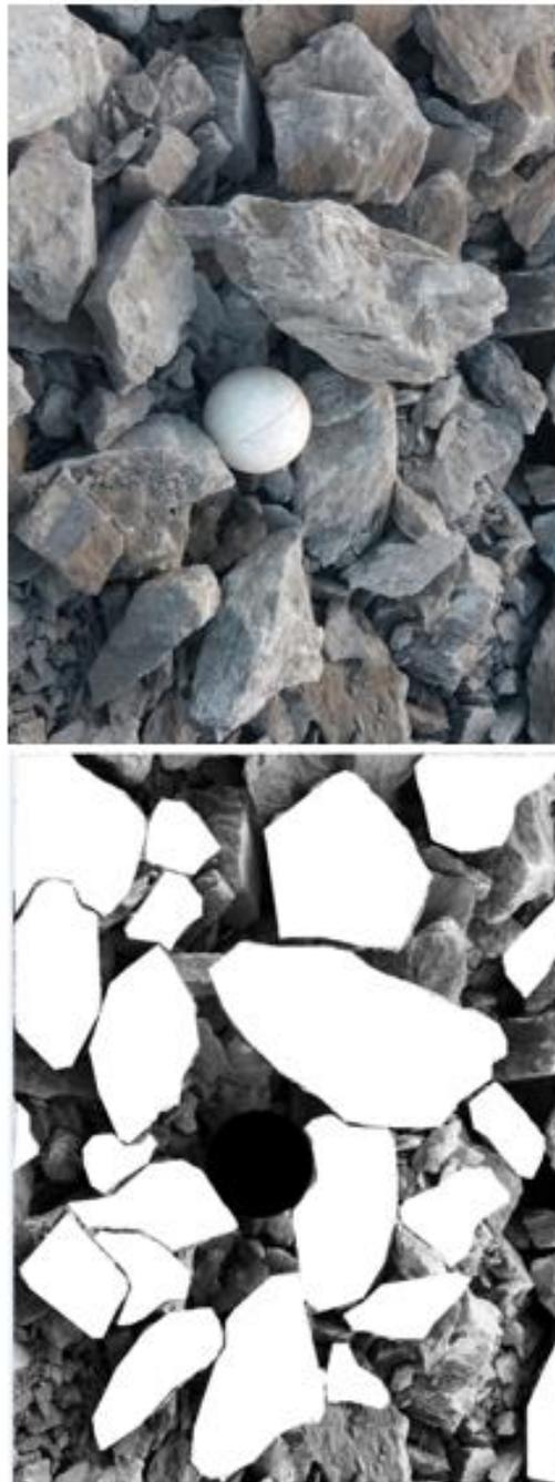
*Figura 13 - Análise Granulométrica após desmonte 002/17*
